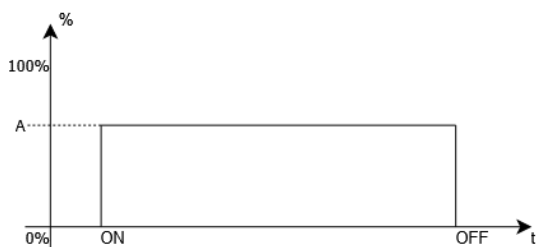
A Velocidad máxima (Setup fabricante - Ventilación)
