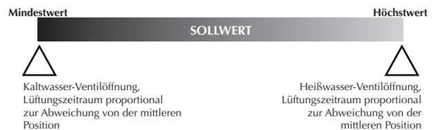
Die Lüftung wird in diesem Fall immer gemäß den ON/OFF-Zyklen ausgeführt, wobei sich dann aber die ON-Phase ab der mittleren Stellung erhöht. Auf diese Weise kann das Liefern der maximalen Lüftung mit dem Wählschalter auf
