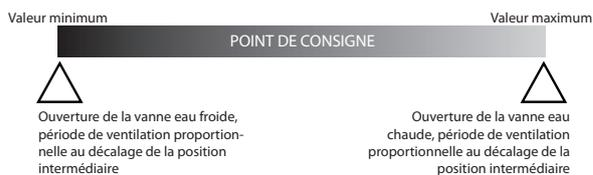
Dans ce cas-là, la ventilation est toujours réalisée d'après les cycles ON/OFF mais en augmentant la phase ON à partir de la position centrale. De cette façon, il est possible d'obtenir la ventilation maximale avec le sélecteur en position mini-
