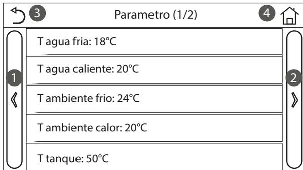
Mediante este menú se pueden configurar los valores utilizados para la regulación de la máquina. Para navegar en este menú el sistema prevé las siguientes teclas:
