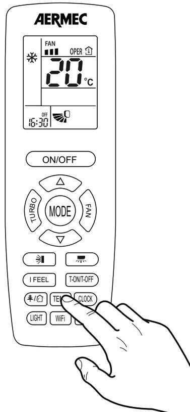
À travers l'utilisation de la télécommande on peut visualiser la valeur de température relevée dans la pièce par l'unité interne ou bien visualiser le paramètre de fonctionnement actuellement utilisé par l'unité ; ces deux informations seront affichées sur l'écran à bord de l'unité intérieure.
