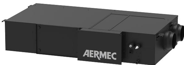
Unità di **recupero di calore** progettate per installazione canalizzata orizzontale in locali interni, è dotata di un recuperatore di calore entalpico a flussi incrociati con efficienza di recupero superiore al 70%. Lo scambiatore permette di trasferire energia dall'aria di espulsione a quella di rinnovo evitando che vi sia miscelazione diretta fra i flussi d'aria.
