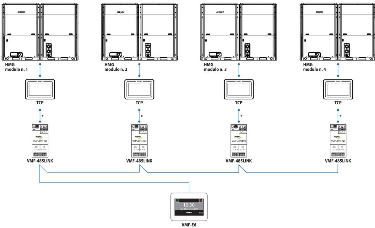
\* Collegamento da effettuare con l'ausilio dell'accessorio IC-2P.
