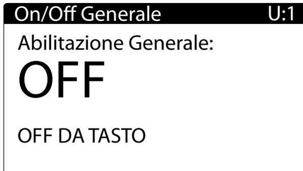
Questa maschera permette di visualizzare lo stato di funzionamento della macchina:
