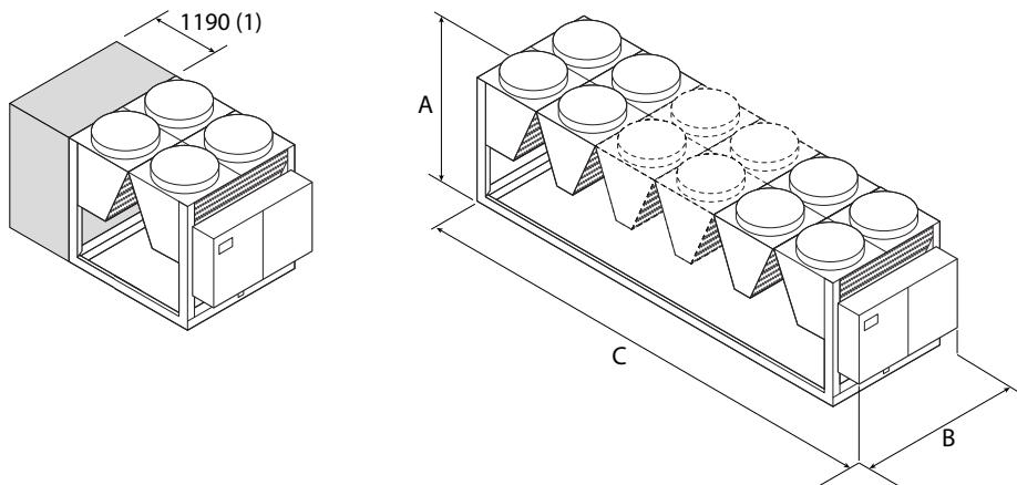
(1) Zusatzmodul für die Aufnahme des Hydronikbausatzes mit Option "Pufferspeicher" notwendig für die Baugrößen:
