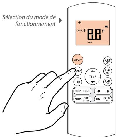
Il n'est pas possible d'activer la fonction REFROIDISSEMENT lorsque la température ambiante est inférieure à 17 °C. Dans ce cas, il est possible d'activer le bouton MANUAL CONTROL pour tester la fonction COOL de cette manière :
