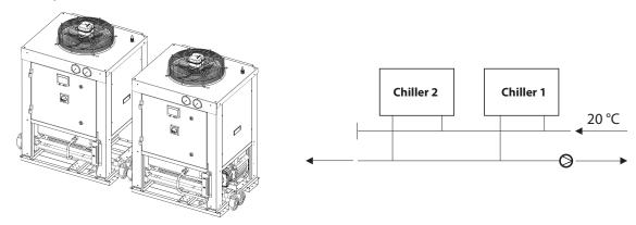
La enfriadora con la bomba debe ser la primera de la «cadena» y la posición de la entrada del agua está vinculada.
