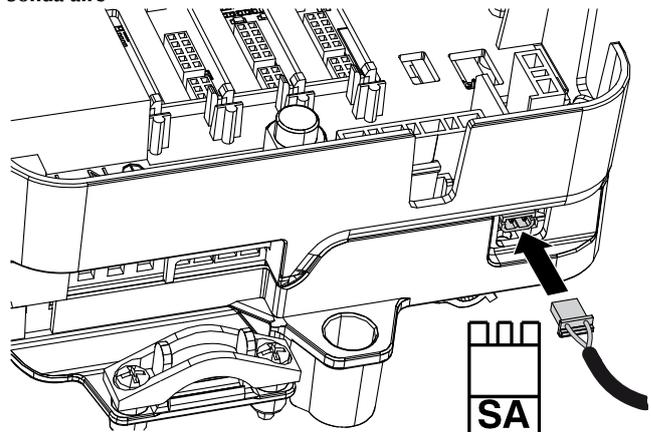
Sonda acqua su scambiatore riscaldamento
