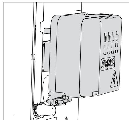
**GEFAHR:** Die Schraube auf der Seitenwand des Gebläsekonvektors muss unbedingt eingeschraubt werden, da sie die Erdung der gesamten Anlage ermöglicht.
