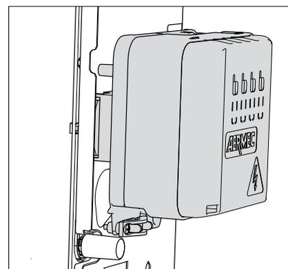
PELIGRO: es obligatorio enroscar el tornillo en el lado del fan coil, dado que este permite la puesta a tierra de toda la instalación.
