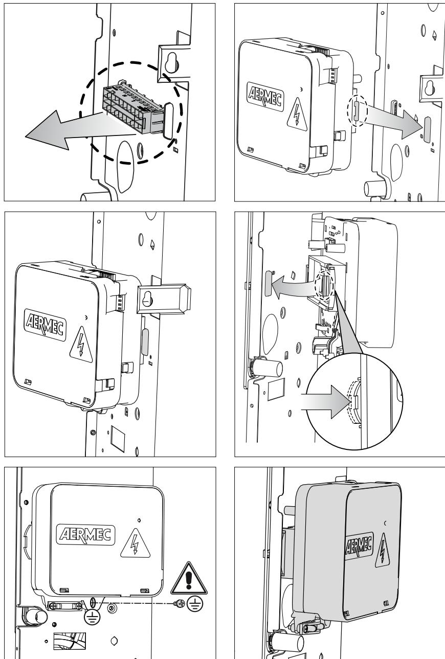
**DANGER : Il est obligatoire de serrer la vis qui fixe le boîtier du thermostat sur le flanc du ventilo-convector, afin de garantir la mise à la terre de toute l'installation.**
