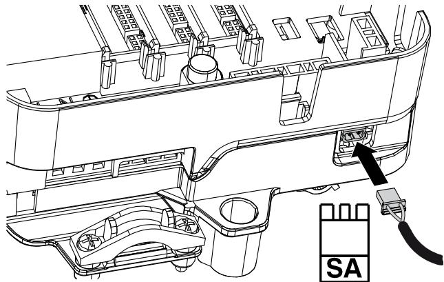
Sonda acqua su scambiatore riscaldamento
