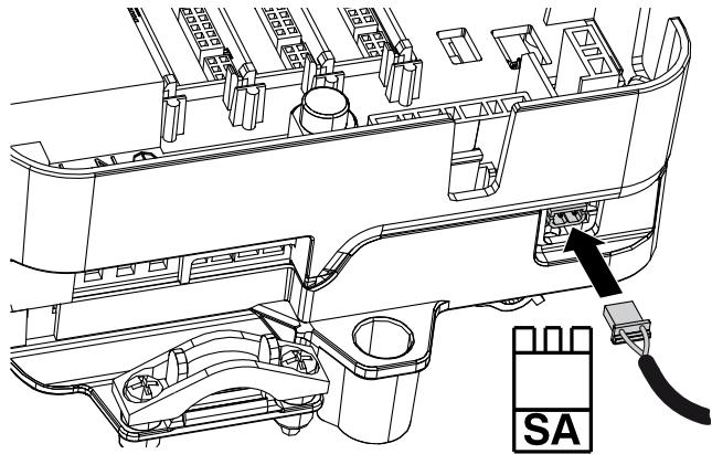
Sonda acqua su scambiatore riscaldamento
