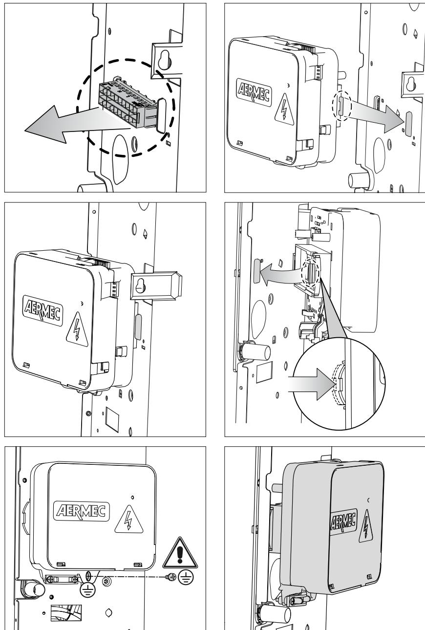
**PELIGRO:** Se debe enroscar el tornillo que fija la caja del termostato al lateral del fan coil, puesto que la misma permite la puesta a tierra de toda la instalación.
