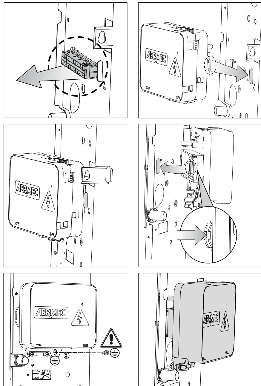
**GEFAHR:** Die Schraube, die das Gehäuse des Thermostats an der Seitenwand des Gebläsekonvektors fixiert, muss unbedingt eingeschraubt werden, da sie die Erdung der gesamten Anlage ermöglicht.
