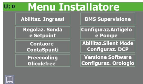
1. Indica a quale compressore si riferiscono i dati visualizzati (U:1 = Master; U:2 = Slave 1; U:3 = Slave 2; U:4 = Slave 3)
