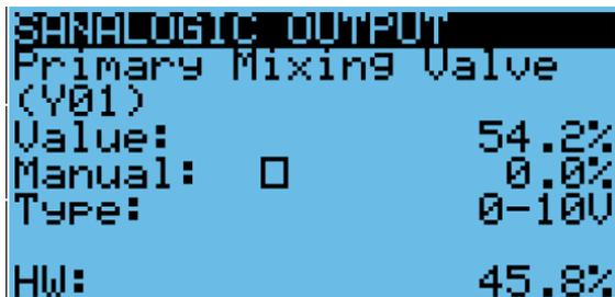
4. Analogausgänge: Wert Anzeige des Ausgabe-werts; Manuell gestattet die Aktivierung des Ausgangs bei einem einstellbaren Wert; Typ Anzeige des Signaltyps; HW Anzeige des Hardwarestatus des Ausgangs
