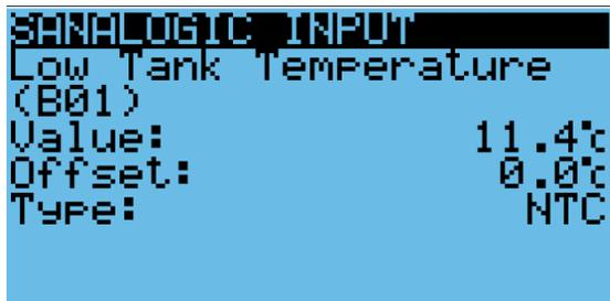
1 Analogeingänge: Wert Anzeige des ausgelesenen Werts; Offset Korrektur des ausgelesenen Werts; Typ Auswahl des Fühlertyps, NTC oder NTC-HT.
