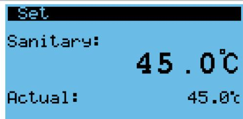
← drücken, der Cursor blinkt neben der Temperatur °C. Mit den Pfeiltasten ↑/↓ die Temperatur auf den gewünschten Wert einstellen, zum Bestätigen und Verlassen ESC drücken
