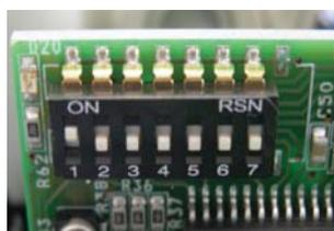
NB: I dip-switches n° 1, 2, 3 e 7 devono assolutamente rimanere nelle posizioni indicate da Aermec mentre i n° 4, 5 e 6 possono essere modificati in relazione alle portate desiderate.
