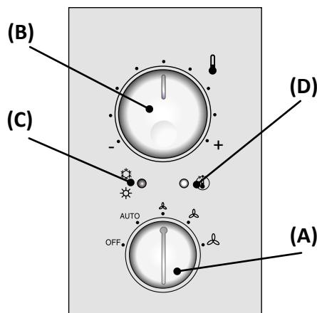
– (D) Kontrollämpchen zur Anzeige der Lüftungsansteuerung GELB
