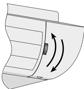
Ausblasrichtung nach Vorn oder nach Oben, wählbar mittels Wahlschalter.
