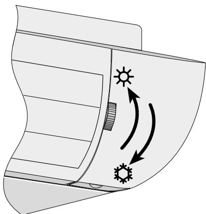
Commutazione mandata dell'aria e modo di funzionamento mediante selettore sull'unità.
