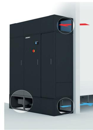
Esecuzione per installazione all'esterno del Data Centre, senza pavimento sopraelevato e mandata posteriore. In questo caso la sottobase è fornita di pannelli di chiusura laterali e griglie di mandata posteriori. L'installazione del plenum con sistema di ripresa posteriore è opzionale, in mancanza di un sistema di canalizzazione.
