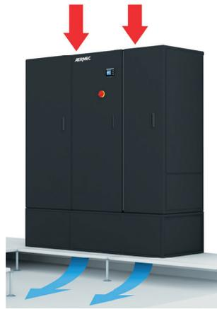
Esecuzione per installazione perimetrale all'interno del Data Centre. In questo caso, la sottobase fornita di pannelli di chiusura laterali, dovrà essere installata sopra il pavimento. È comunque indispensabile verificare che l'altezza del soffitto permetta una buona aspirazione dell'aria.
